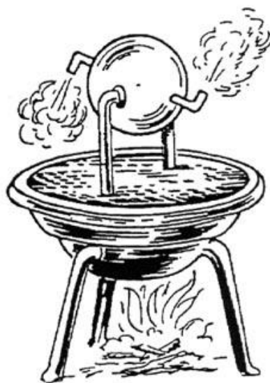
рис 1. Шар Герона ( http://all-pix.com/geron-aleksandriyskiy-ego-izobreteniya )
