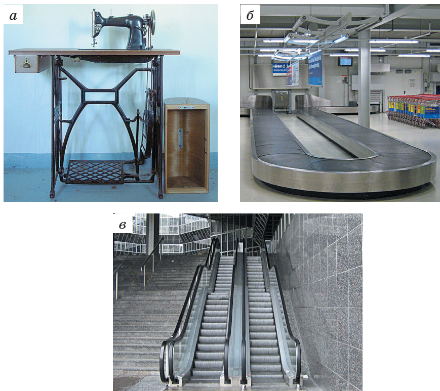
Рис. 14.3. Применение ременной передачи: а — швейная машина; б — багажный транспортёр; в — эскалатор
