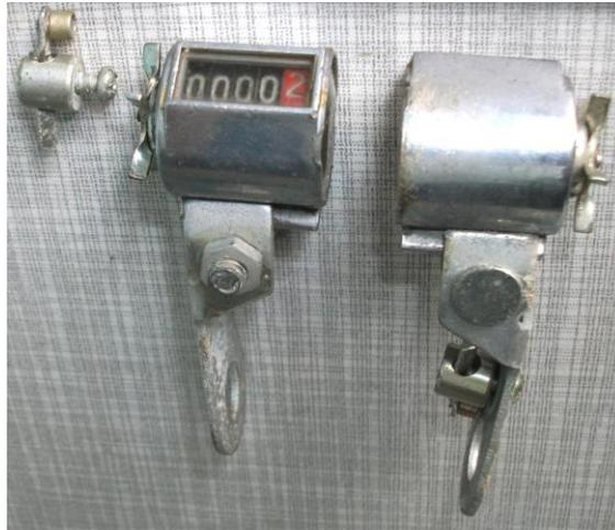
**Рис. 6.** Механический счётчик пробега
