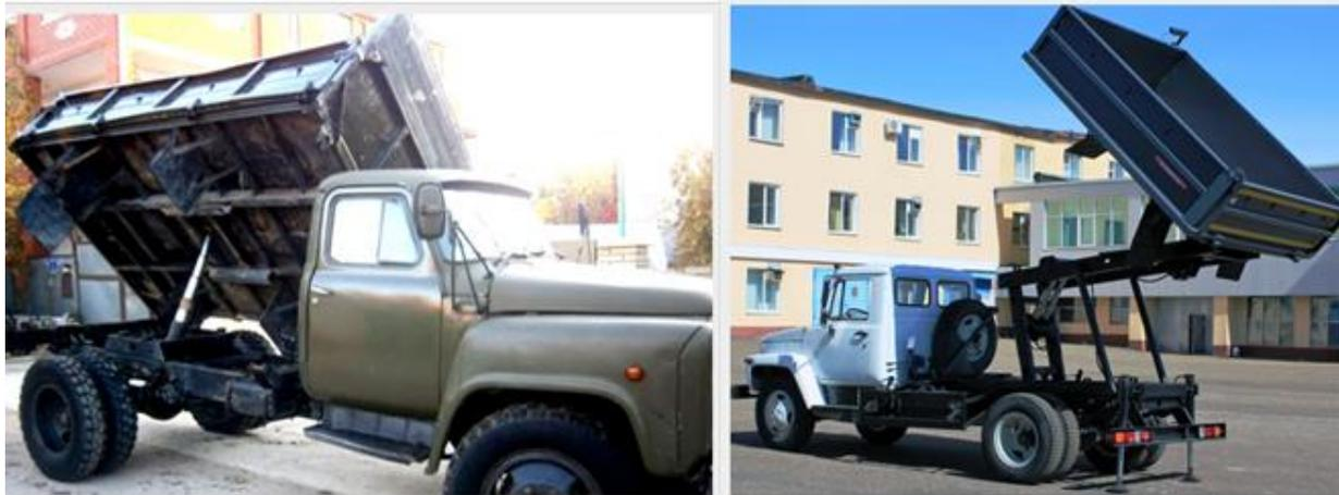
**Рис. 12.** Подъёмники самосвалов
