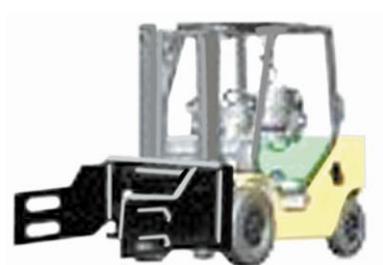
**Рис. 13.** Вилочный подъёмник с различным навесным оборудованием
