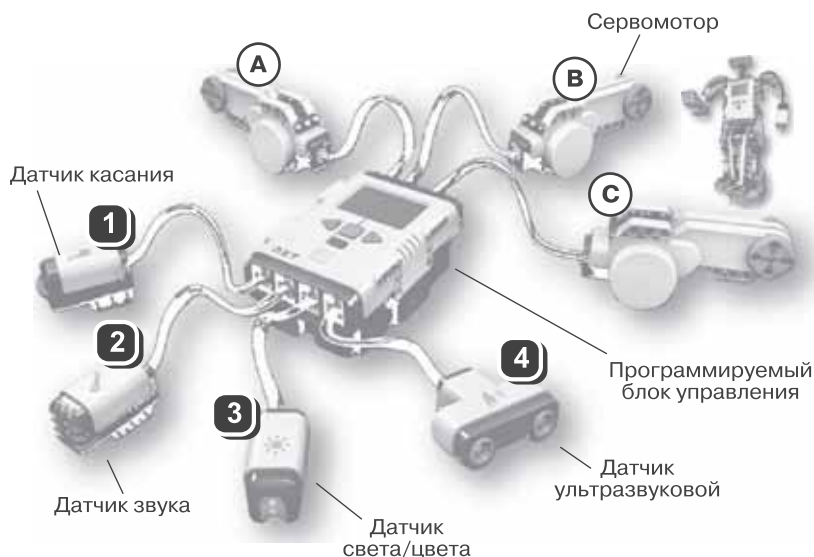
Рис. 1. Структура набора LEGO Mindstorms NXT
