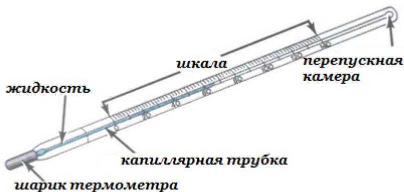
Рисунок 4. Устройство жидкостного термометра
