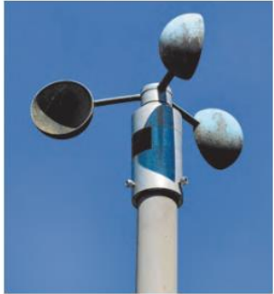
Рис. 3. Анемометр — прибор для измерения скорости ветра
