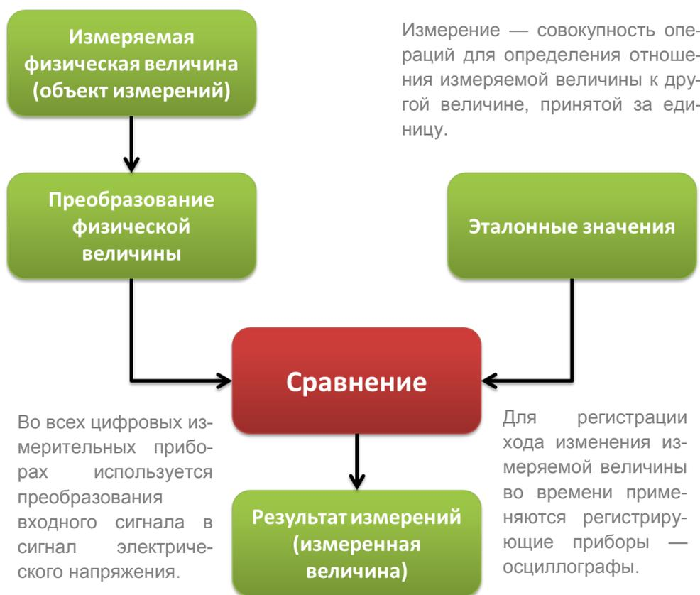
Измерение заключается в сравнении величин. Сравнение может быть непосредственное или косвенное. Например, уровень жидкости в сосуде можно измерить непосредственно — нанести градуированную шкалу. Температуру всегда измеряют косвенно: по уровню жидкости, сопротивлению материала, т.е. используется другая физическая величина. Измерение любой физической величины проводится с помощью различных средств измерений — мер, измерительных приборов, измерительных преобразователей, систем, установок и т. д.
