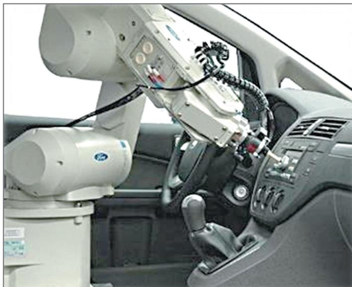
**Рис. 76.** Робот тестирует салон автомобиля
