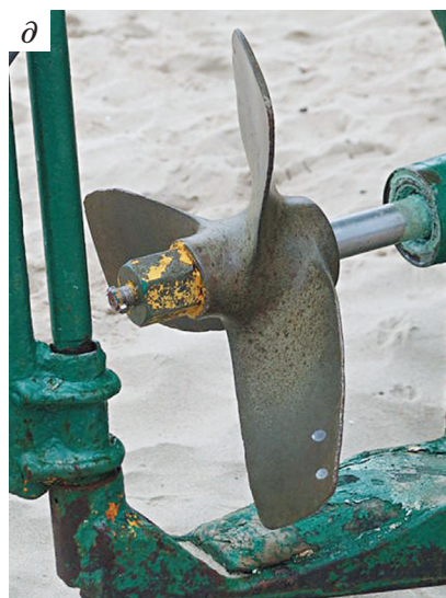
Рис. 12.2. Применение винта: а — шнек; б — сверло; в — мясорубка; г — пропеллер; д — гребной винт
