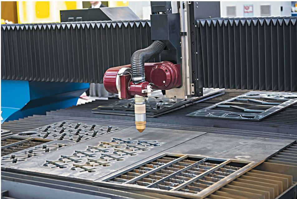
Рис. 8.2. Резка при помощи лазера
